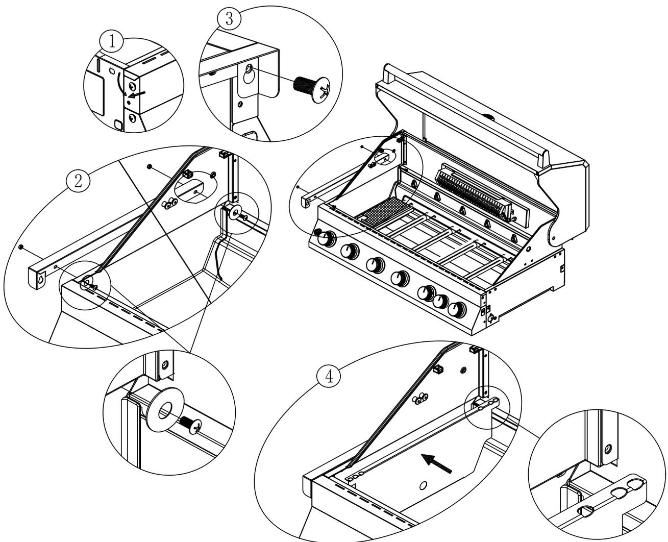
**Hinweis:** Bei der Verwendung von Grillrosten aus Gusseisen montieren Sie die Isolierplatten bitte wie abgebildet. Grillroste aus Edelstahl sind optional erhältlich.
