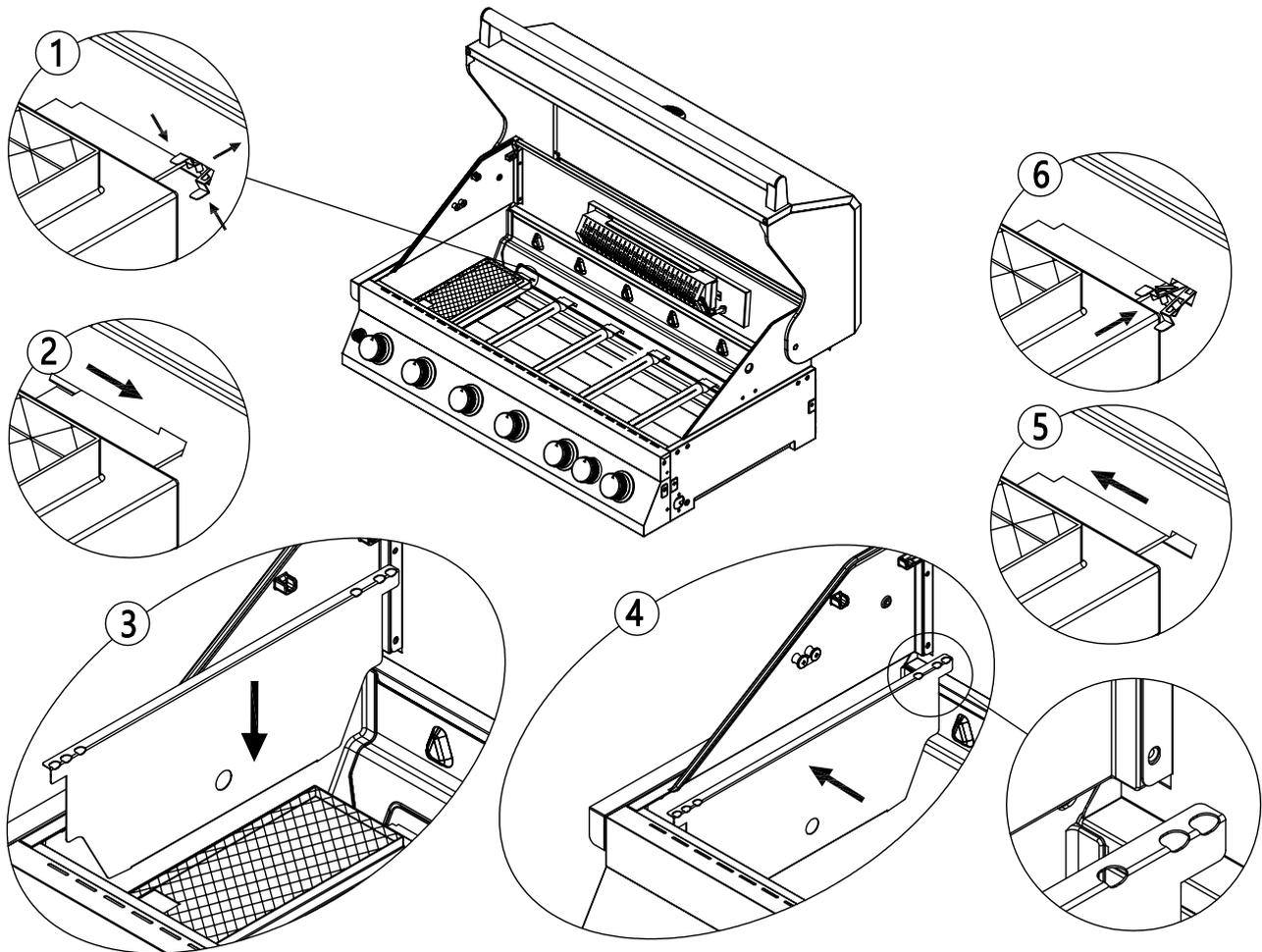
**Hinweis:** Da der Infrarotbrenner auf der linken Seite platziert ist, sollten Sie diesen zum leichteren Einsetzen der Isolierplatte zunächst lösen. Drücken Sie dazu die Halteklammer auf der Rückseite des Feuerkastens zusammen und schieben diese durch die Rückwand (1). Bewegen Sie den Brenner anschließend bis zum Anschlag nach rechts (2). Nun können Sie die Isolierplatte einsetzen (3, 4). Schieben Sie den Brenner wieder nach links (5) und fixieren Sie den Brenner mit der Halteklammer (6).
