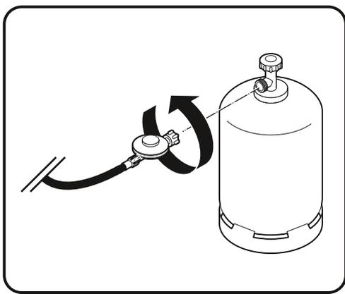
Stellen Sie eine Seifenlösung aus einem Teil Spülmittel und einem Teil Wasser her. Sie benötigen eine Sprühflasche, eine Bürste oder einen Lappen, um die Lösung auf die Anschlüsse aufzutragen. Für die Dichtheitsprüfung ist sicherzustellen, dass die Gasflasche zu 80 % gefüllt ist.
